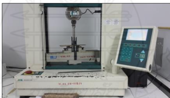
ภาพที่ 2 การทดสอบความต้านทานแรงดัด
