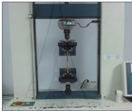
ภาพที่ 3 การทดสอบความต้านทานแรงดึง
